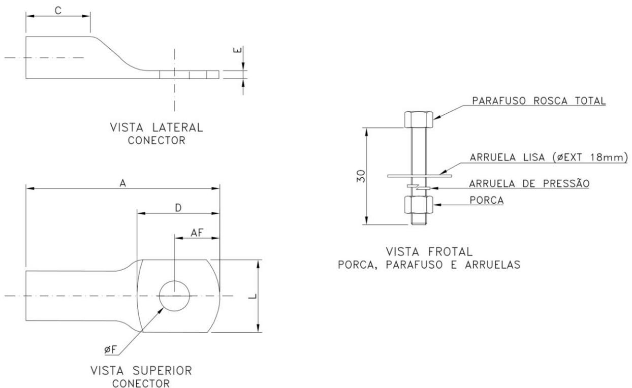
**Figura 1** - Conector Terminal a compressão para utilização em medição
